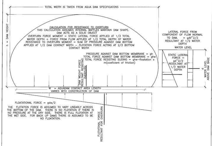
12' HEIGHT AQUADAM, 30.83' LAY FLAT, 25' FILLED WIDTH, 22' EST. GROUND CONTACT WIDTH 8' HEIGHT AQUADAM, 21.67' LAY FLAT, 17' FILLED WIDTH, 16' EST. GROUND CONTACT WIDTH
